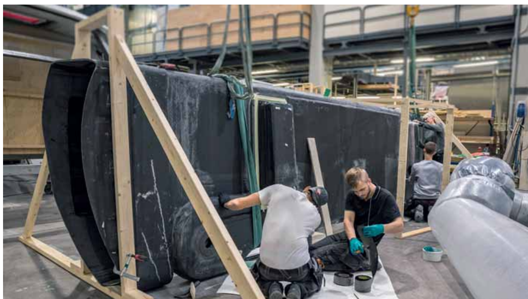
In alto uno dei componenti cruciali della costruzione della barca, la cassa di alloggiamento del Foil DSS.
