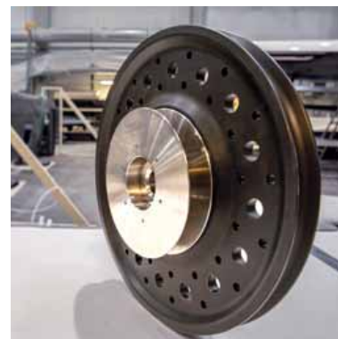
In alto, una delle puleggie interne che azionerà il circuito del Foil DSS.
