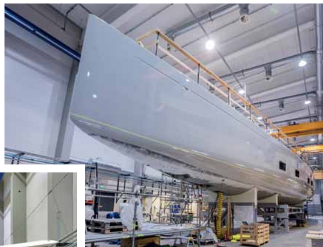
Sopra, lo scafo in avanzata fase di costruzione, si notano i volumi di prua che tradiscono il DNA anche sportivo di questo progetto.
